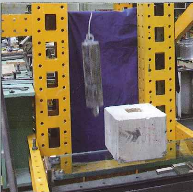
Test du cylindre(1): chute d'une hauteur de 80cm
